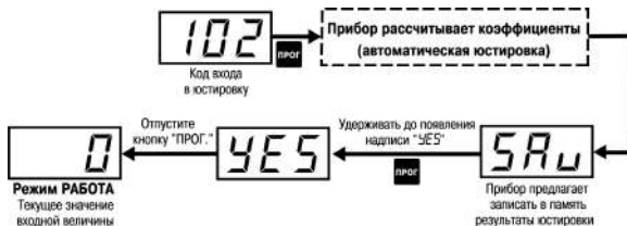
Рисунок 8.8 – Последовательность действий при юстировке схемы компенсации температуры свободных концов термопары
