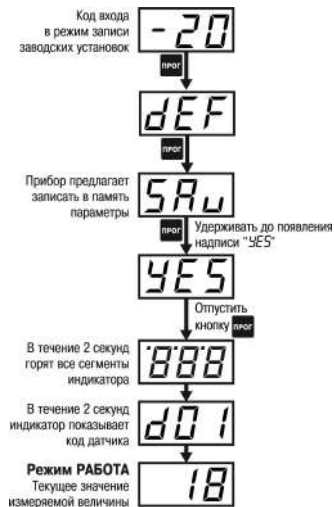
Рисунок 7.17 – Схема восстановления заводских установок
