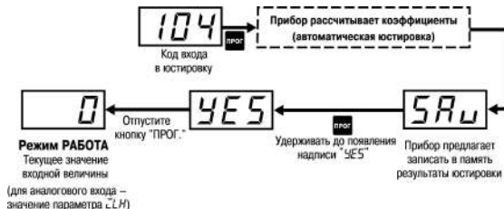
Рисунок 8.2 – Схема юстировки наклона характеристики ТС или датчика с унифицированным выходным сигналом
